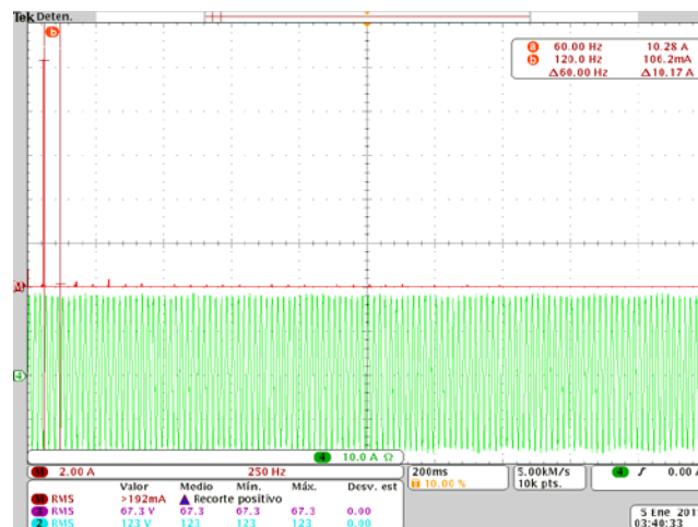
Figura 14 Forma de onda de la corriente de línea y su espectro en frecuencia.
